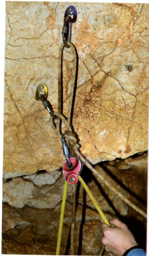
Assurance par installation d'une mini traxion.
