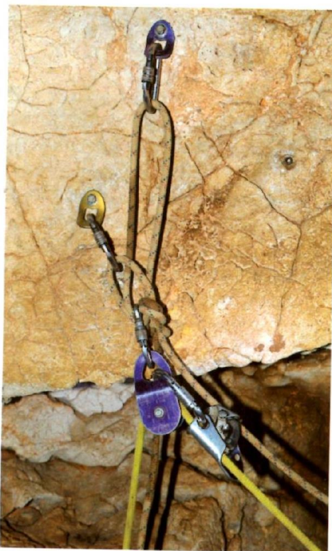
Assurance par installation d'un poulie-bloqueur.
