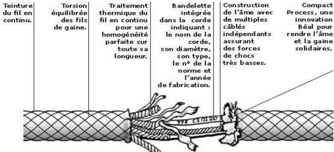
Figure 3. Détail de la fabrication de la corde de spéléologie Béal.
